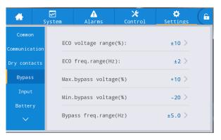
Fig. 4-22 Bypass parameters interface
