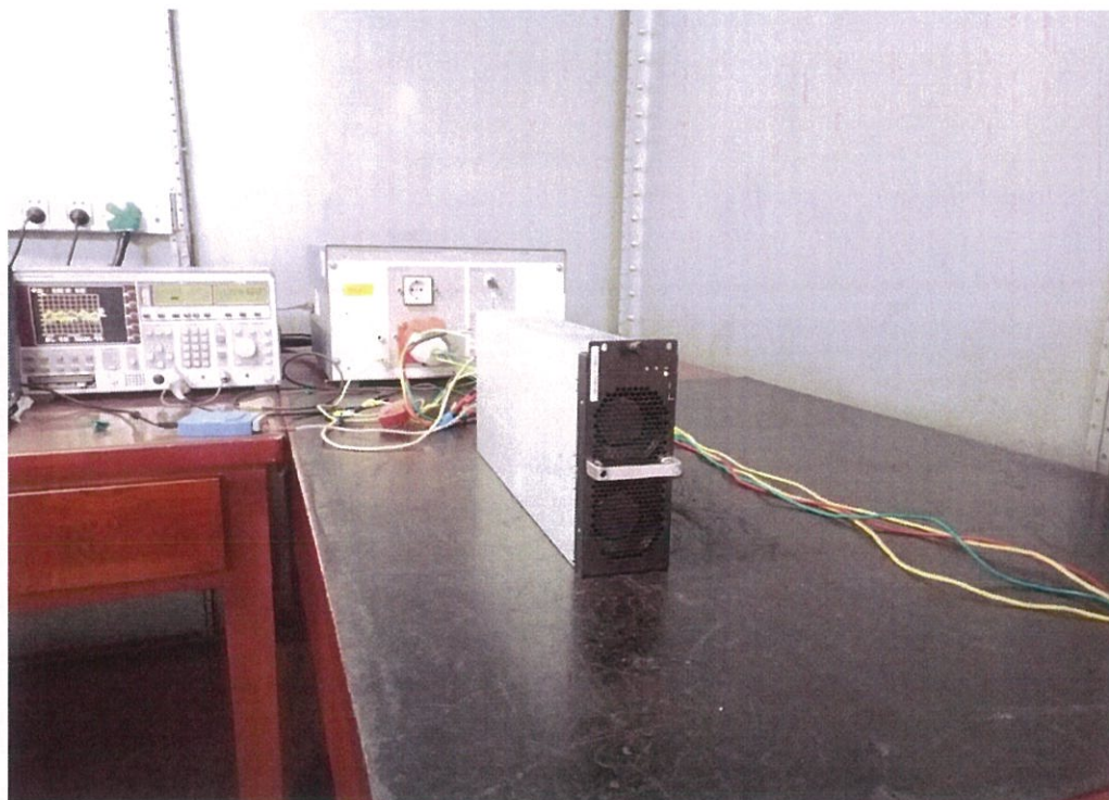
图 6: 传导发射限值检验配置图
