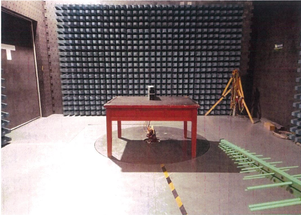
图 7: 辐射发射限值检验配置图
