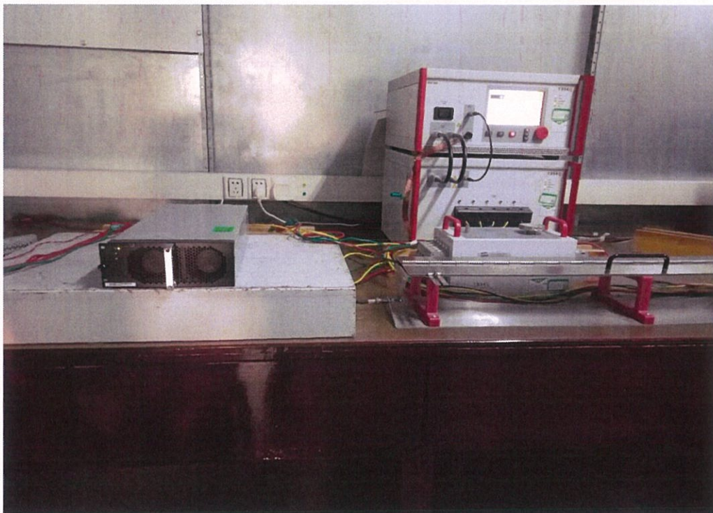
图 4: 浪涌抗扰度检验配置图
