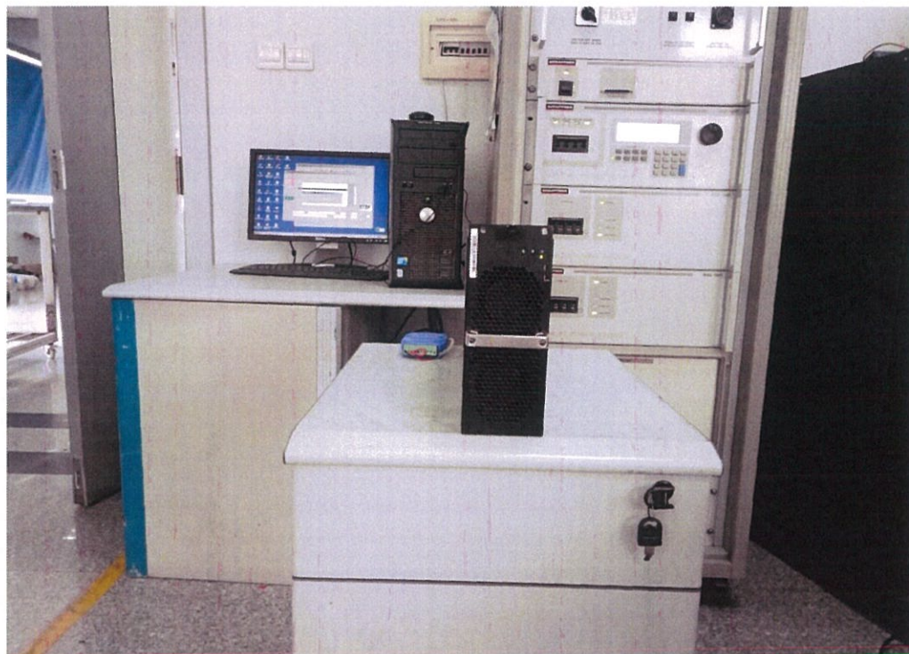
图 5: 电压暂降、短时中断抗扰度检验配置图
