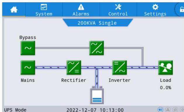
Fig. 2-8: LCD display
