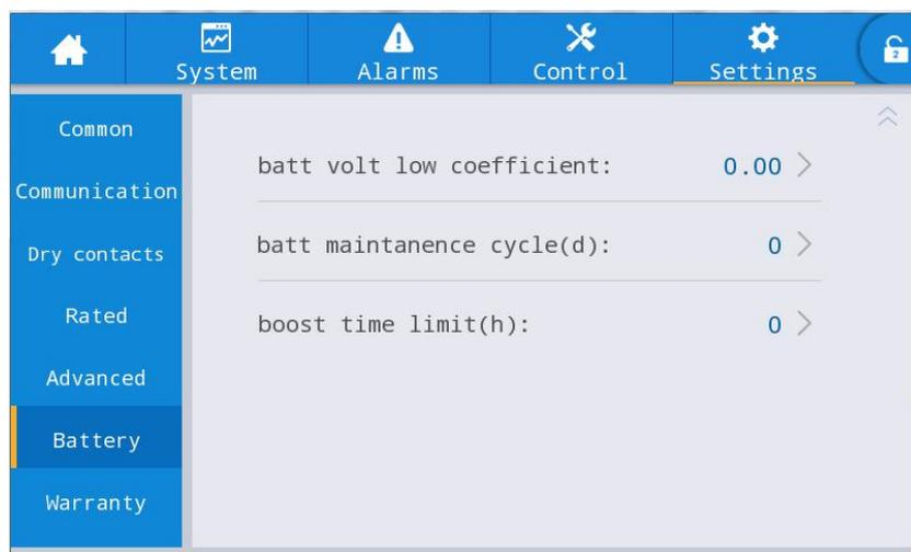
Fig. 4-19 Battery parameters interface
